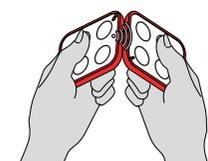
Scambio del codice di abilitazione fra un trasmettitore già memorizzato ed uno nuovo, da memorizzare.
