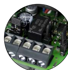
SELEZIONE USCITA RELÈ N.C. -N.A. O 8,2K \Omega TRAMITE JUMPER.
